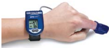
Рис 16. Компьютерный пульсоксиметр с отражающей технологией регистрации сигнала PulseOx 7500 (SPO Medical, Израиль).
